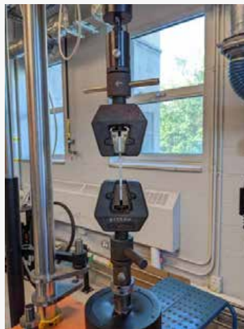
Vérification de l'impact sur la résistance à la traction [ISO 527:2012]
